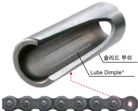
쓰바키 범용 롤러 체인 「G7-EX」는 독자적인 가공 기술을 통해 이음매가 없는 「솔리드 부쉬」를 개발. 고정밀도 솔리드 부쉬는 특수 Lube Dimple(LD)가공※에 의해 윤활유의 보유 효과를 향상시켜 마모 수명 2배를 실현했습니다.
