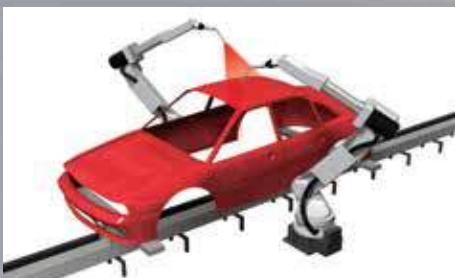
상도는 도장 로봇이나 레시프로식 도장기로 실제 자동차 색을 스프레이 도장을 해서 얼룩 없이 예쁘게 마무리합니다. 레시프로 도장기에는 쪼바키 드라이브 체인과 감속기가 사용되고 있습니다.
